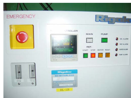
冷ガス発生装置 スイッチ類・温度コントローラ
