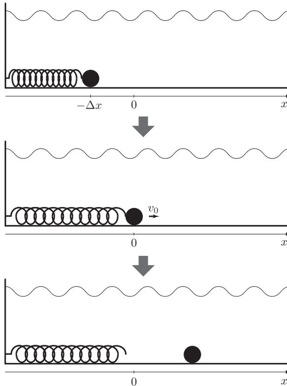
(1) 水平右向きを正の向きに  $x$  軸をとり、バネがつりあいの位置にあるときの金属球の中心位置を  $x = 0$  とすると、上の仮定により時刻  $t = 0$  において金属球の中心は  $x = -\Delta x$  にある。外力を解いた（手をはなした）後、バネがつりあいの位置に戻るまでの金属球の中心の  $x$  座標  $x(t)$  に関する運動方程式を書き下せ。ただし、金属球はバネの弾性力と粘性抵抗力のみを受けて運動するものとし、また粘性抵抗力の大きさは速度に比例しその比例定数は  $\kappa$  であるとせよ。
