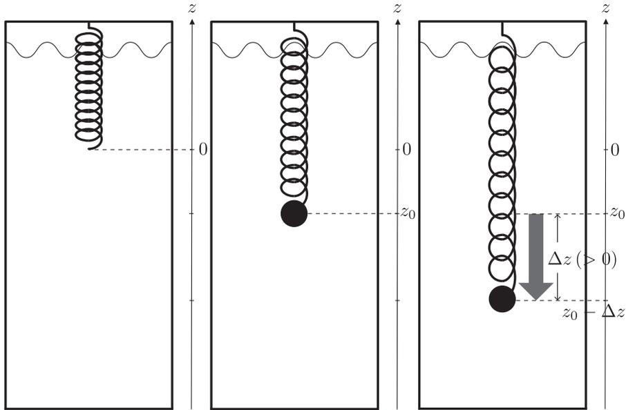
(1) 真ん中の図のように、球体をバネの先端につなぎ、重力、浮力、弾性力が釣りあう位置で静止させる。このときのつりあい位置  $z_0$  を求めよ。ただし  $m > \rho_0 V$  (すなわちバネがなければ球体はこの流体中沈む) とする。
