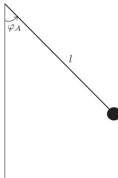
最大振れ角  $\varphi_A$  が  $45^\circ$  のとき、周期  $T$  は微小振動の周期  $T_0 = 2\pi\sqrt{\frac{l}{g}}$  と比べてどれだけ大きいのか。被積分関数  $\frac{1}{\sqrt{1 - k^2 \sin^2 \theta}}$  を  $k^2 = 0$  のまわりで  $k^2$  について1次までのテーラー展開で近似し、項別に積分して(微小振動の周期との比)  $-1 (= \frac{T}{T_0} - 1)$  を有効数字2けたまで求めよ。
