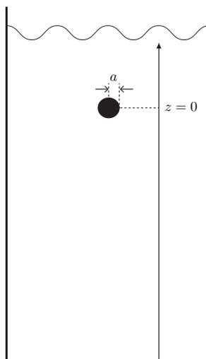
鉛直上向きを正の向きに  $z$  軸をとり、時刻  $t = 0$  で球体はその中心が原点  $z = 0$  の位置で静止しているものとして、以後球体が重力、浮力、粘性抵抗力の3種類の力のみを受けて行う鉛直方向の運動について次の問いに答えよ。ただし  $m > \frac{4}{3}\pi\rho_0 a^3$ 、すなわち球体はこの流体中沈むものとし、またあらゆる時刻において球体全体が粘性流体に浸っているとす。
