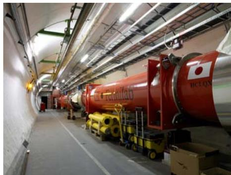
アトラス実験の衝突点近くに設置された超伝導四極マグネット
