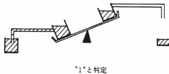
図 I-31 メモリセル用バケツの水位が半分以上か否かを判定する仕掛け
