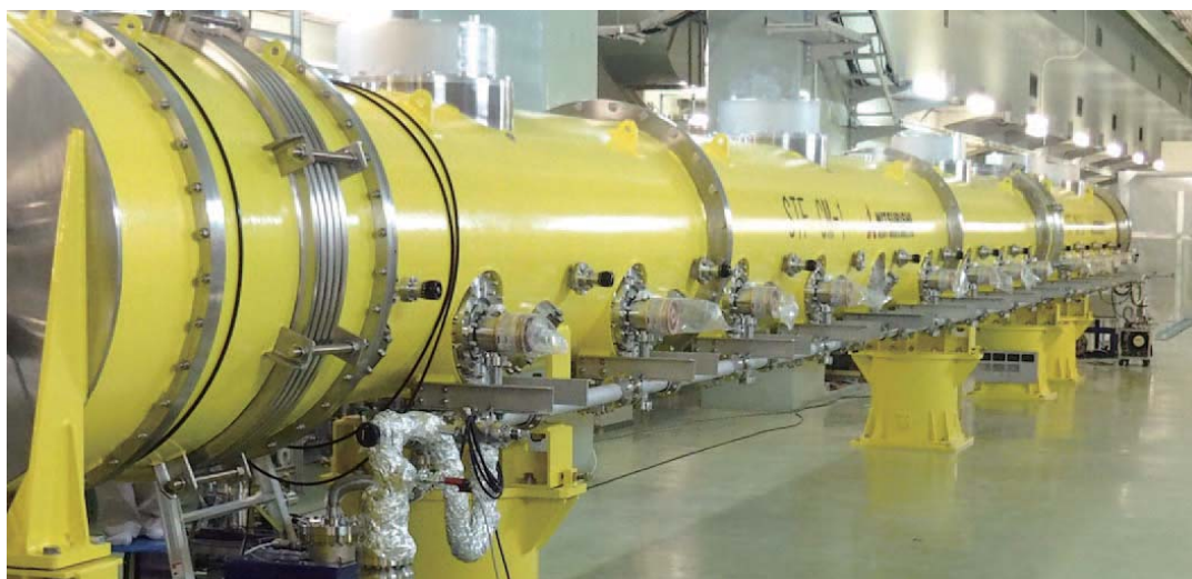
②-図 1. STF トンネル内の 12 m 長加速モジュールと 6 m 長ハーフサイズ加速モジュール
