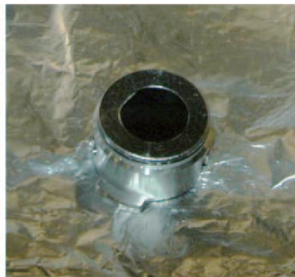
④-図 15. アルキリアンチモン蒸着のためのシリコン基板をモリブデン製のパックにセットした。モリブデンパックは cERL と互換性のある設計となっている。
