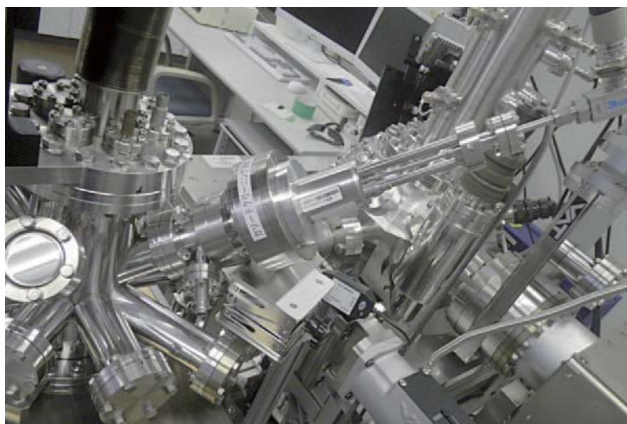
⑧-図7. スパッタ用真空チャンバーに設置されたカソードクリーニング装置。
