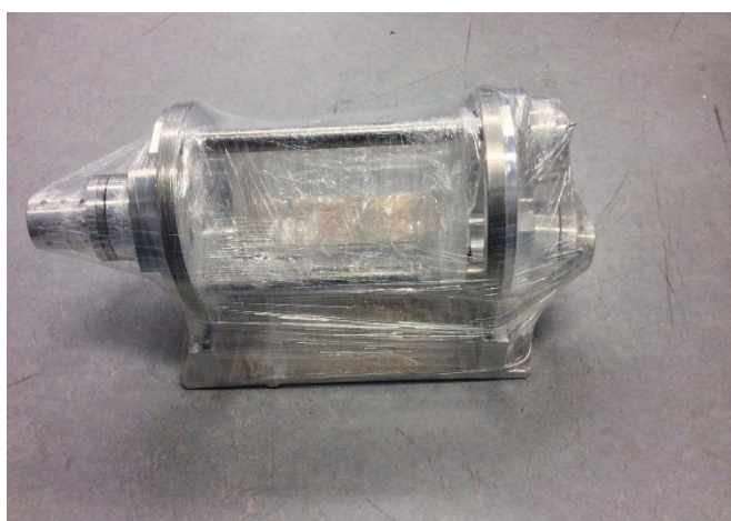
③-図14. 広島大学における、共振器制御技術開発のために作製した3次元4枚鏡共振器。この後、クリーンルームに設置するため、保護のビニールがかけられている。
