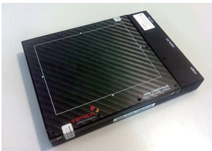
⑤-図 2. 実験で採用した CMOS 検出器 (RAYENCE, 1215CF-MP)。
