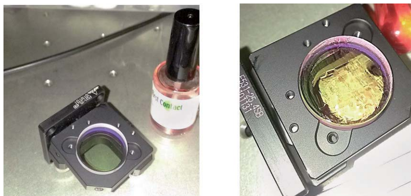
③-図 11. 薬品による鏡洗浄の様子。左図は薬品(瓶)と薬品を塗布する前の鏡。右図は薬品を塗布した様子。この後、乾いた薬品をはがすことによって、鏡表面の汚染物を除去する。
