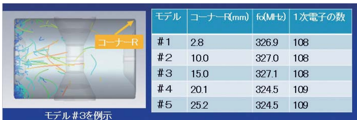
⑨-図 10. シングルスポーク 325 MHz 空洞モデルのコーナー R の定義。コーナー R は最小 2.8 mm から 25.2 mm まで 5 種考慮した。
