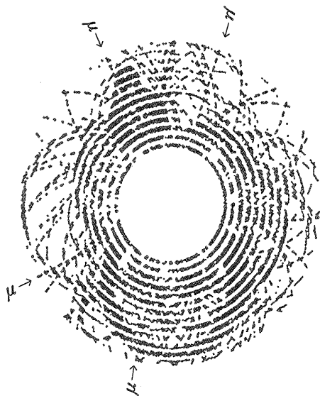
図7 H \rightarrow ZZ \rightarrow \mu^+ \mu^- \mu^+ \mu^- を飛跡検出器でどのように見えるか計算機シミュレーションしたもの。ヒッグスの質量は 400 GeV とした。ヒッグスからの \mu 粒子は矢印で示してある。他の飛跡は同時に発生した低エネルギー粒子。
