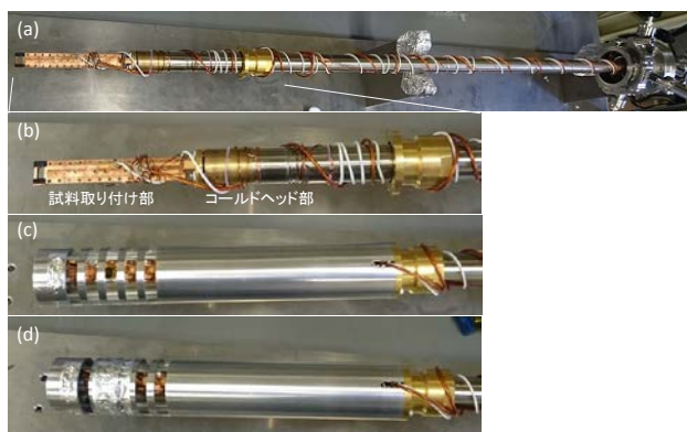
図4 (a) He フロー型冷凍機の全体像。(b) 試料・コールドヘッド部の拡大図。輻射シールドを取り付けた状態で、開いているX線窓の数が(c)5か所。(d)3か所。
