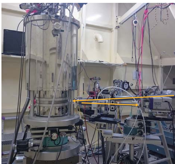
図4：超伝導磁石搭載冷凍機と2軸回折計。この装置の磁場印加方向は鉛直方向。また、この実験では入射X線と出射X線の位置が近く、高角側で格子変化を二次元X線検出器が利用して観測していたものと推測されます。
