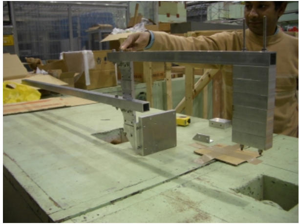
Figure 4: ホール素子支持アーム。バランス用のおもりと3軸架台ステージへの取り付け治具を製作した
