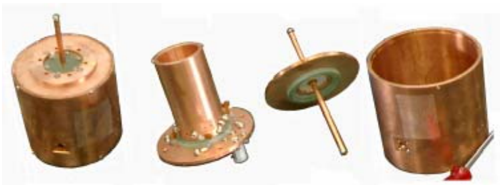
図2-1 試作した円筒型高電圧プローブ。左端は組み立てた状態。
