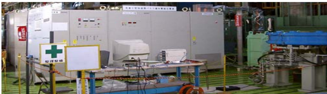
図 2 4 ピーク電流 200kA のパルス電源と 3 T パルス電磁石（右端）
